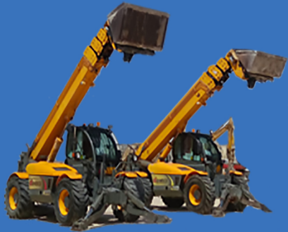
17 METER LONG BOOM TELEHANDLER
